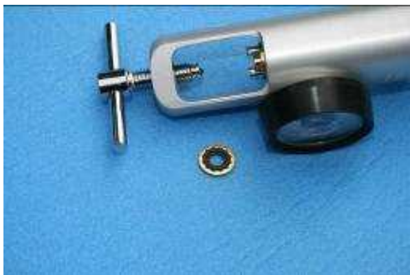
Vérifiez l'état du régulateur et de la rondelle.
