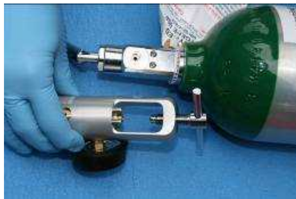
Adaptez le régulateur au détendeur de la bouteille.
